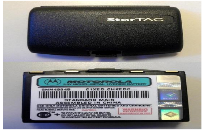
图 51：摩托罗拉 StarTAC 所采用的小型镍氢电池模块
