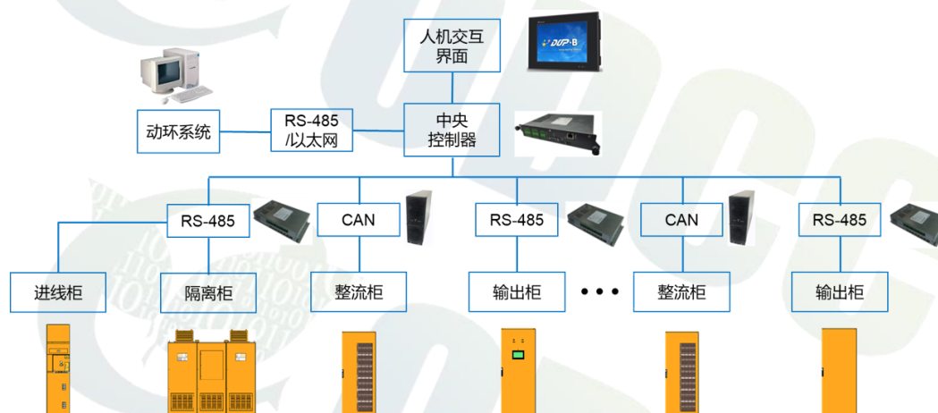
图3-2-4 巴拿马电源方案综合监控架构
