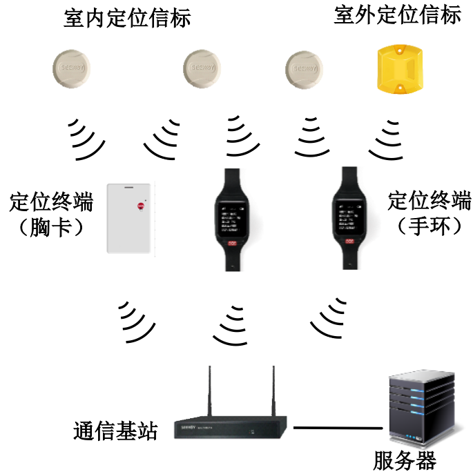
图 3.4-2 蓝牙终端测量定位网络架构
