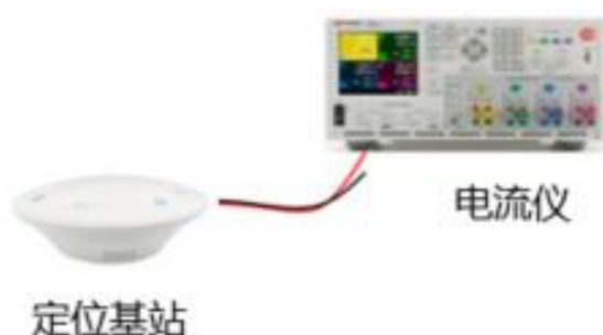
图 4.2-4 基于仪表的定位基站功耗测试系统示意图
