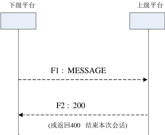
图 5-5 视频通道资源推送流程
