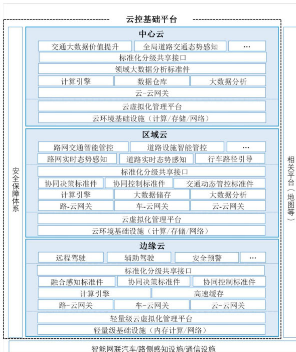
图2 云控基础平台总体框架图
