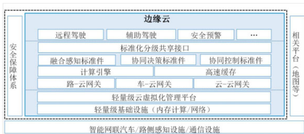
图3 边缘云总体框架图
