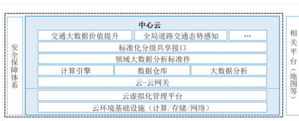
图 5 中心云总体框架图
