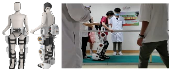
图 39 神工-神甲 脑-机接口神经肌肉电刺激下肢外骨骼康复训练机器人
