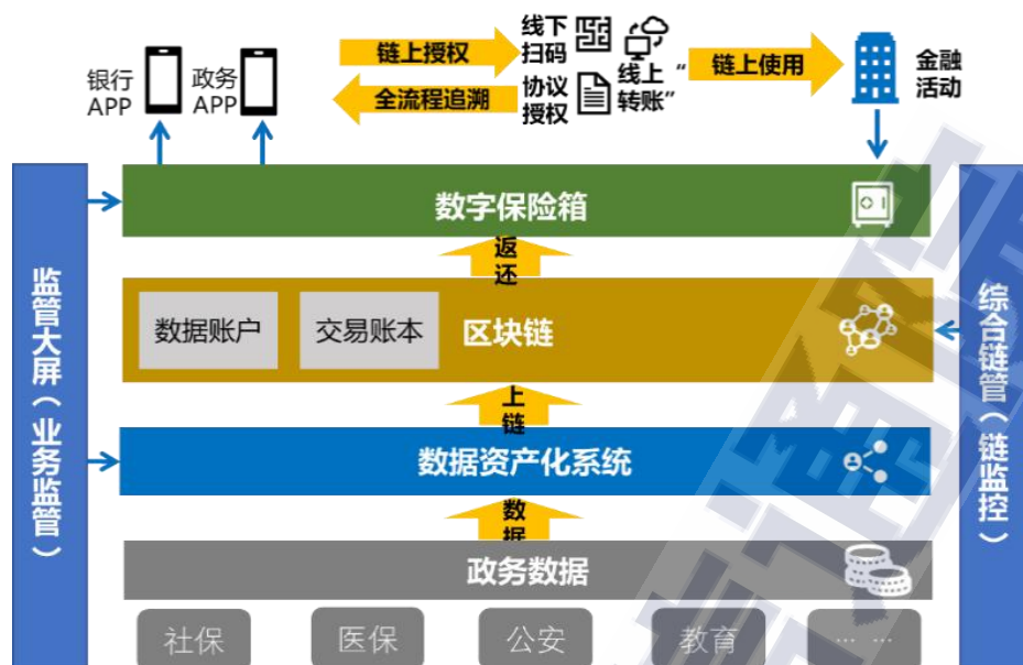
图 92 “大纬链”区块链平台整体架构
