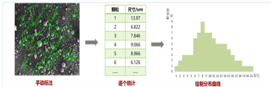
图 18 传统人工 SEM 图像分析流程
