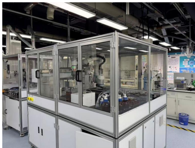
图 17 碳捕集吸收剂高通量自动化开发系统
