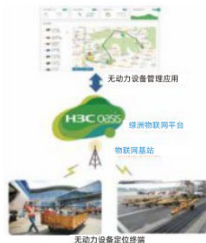
图5 萧山国际机场物联网建设架构图
