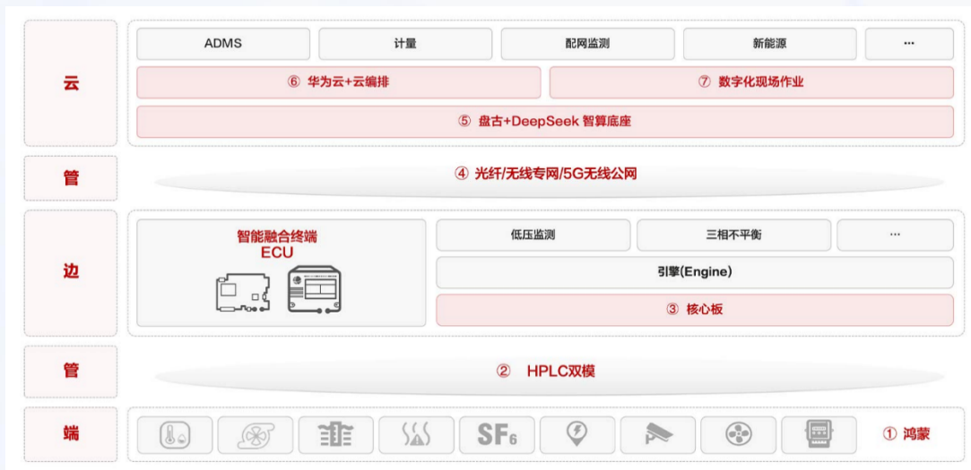
图 8 配电物联网解决方案架构图
